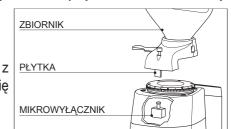
mielącego stanowi umieszczony pod obudową urządzenia mikrowyłącznik, który odcina zasilanie silnika.
