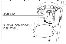
Aby wymienić baterię buforową, wykonać następujące czynności:
